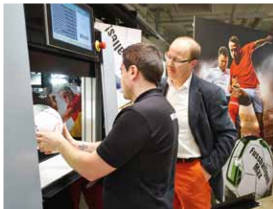
Hier wird gerade ein Fußball mit dem Namen des Eigentümers bedruckt. Möglich macht diese neue Technik zum Bedrucken von 3-D-Objekten die Jetmaster Dimension von HEIDELBERG.
