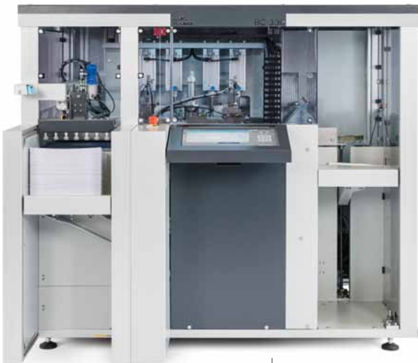
Dreiseitenschneider Polar BC-330: automatischer Beschnitt von klebegebundenen oder sammelgehefteten Produkten.
