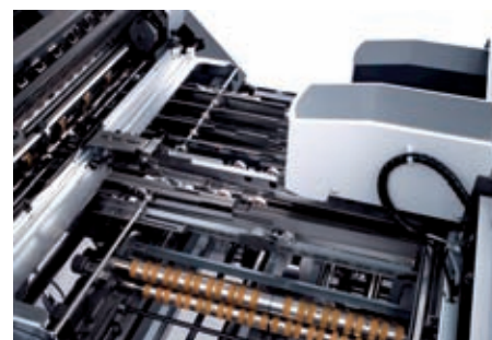
Díky novému výsuvnému systému má obsluha výborný přístup k nožovým hřidelům.
