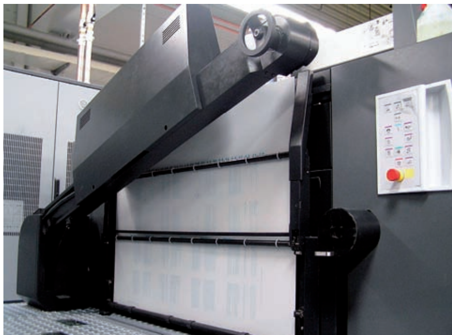
Nový in-line inspekční systém Prinect Inspection Control/PDF na stroji Speedmaster XL 105.
