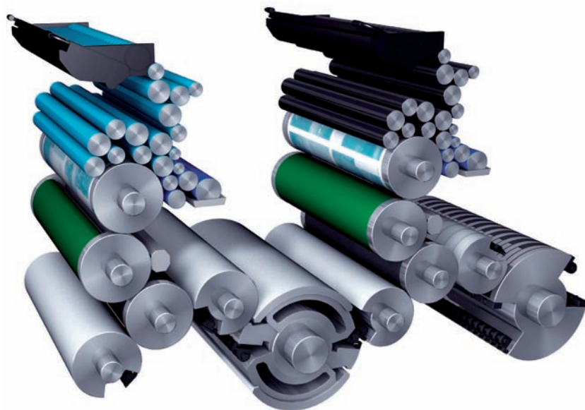
Systém tří převáděcích válců stroje Speedmaster SM 74 je velmi vhodný pro zpracování tenkých materiálů.
