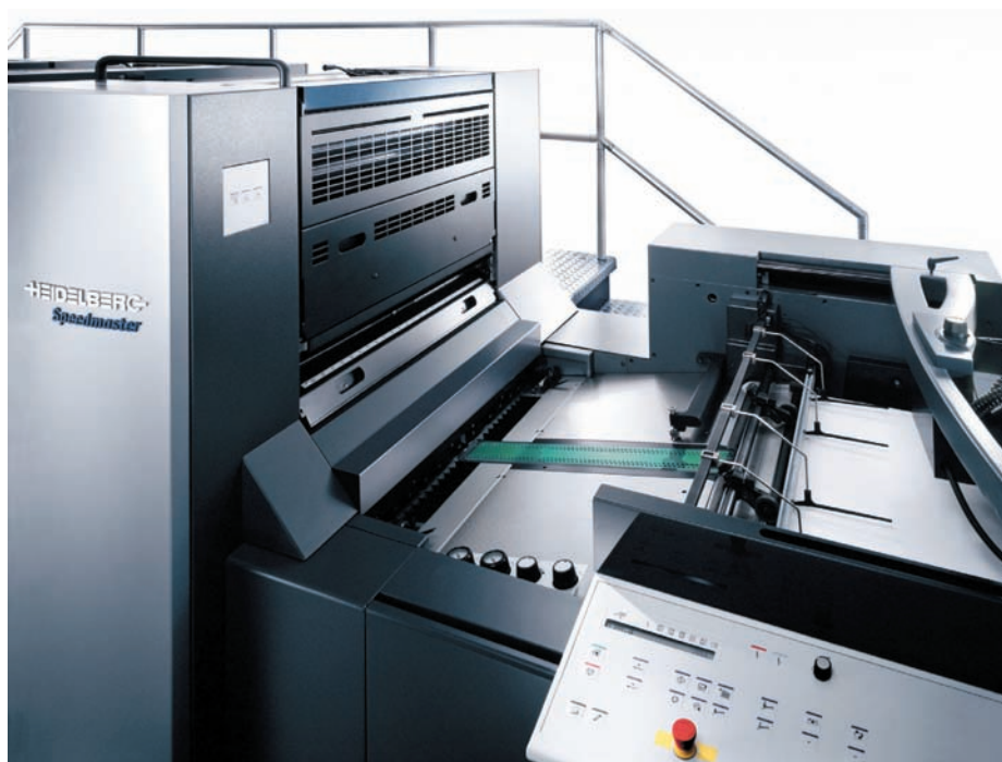
Správnému naložení papírů napomáhá centrální podtlakový pás, díky němuž nehrozí nebezpečí vzniku vln.
