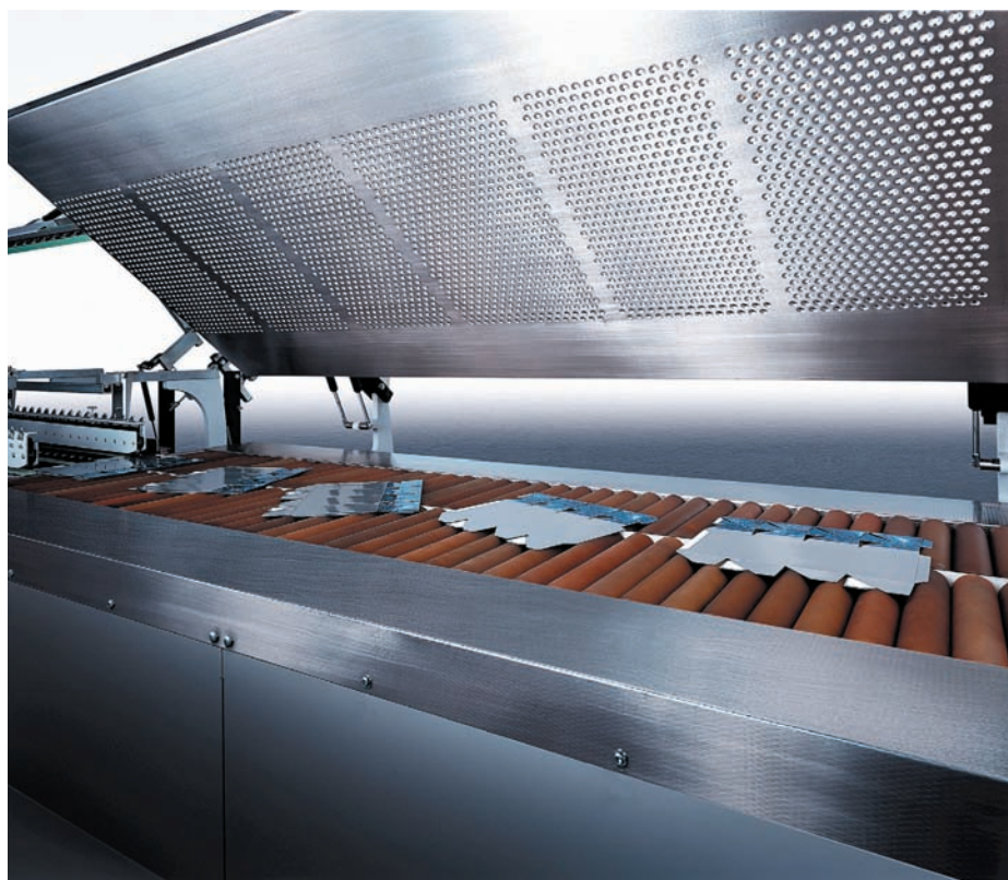
Otáčecí modul stroje Diana 115 X, v němž dochází k otočení produktu o 90°.
