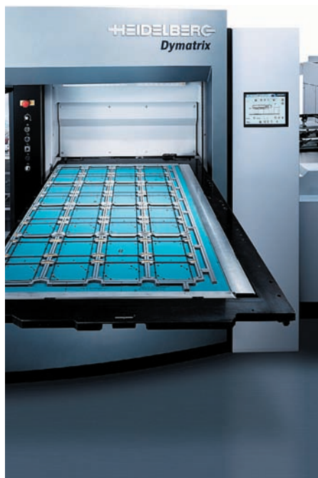
Deska s výsekovou formou na stroji Heidelberg Dymatrix 106 CSB.
