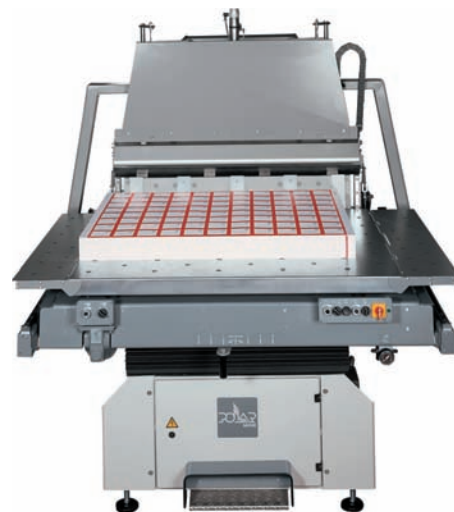
Pro bezproblémové řezání tenkých papírů je nezbytné použít stráscací zařízení s válcem pro vytlačení vzduchu.
