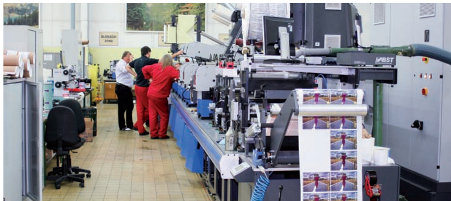
Instalaci nového flexotiskového stroje Gallus EM 410 S se Obchodní tiskárny vracejí k osvědčené švýcarské kvalitě.
