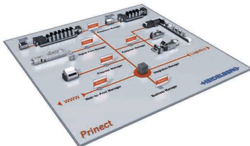
Schematické znázornění plně integrované tiskárny postavené na workflow Prinect.
