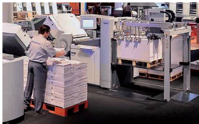
Nový paletový nakladač PFX pro skládací stroje Stahlfolder KH/TH zvyšuje produktivitu až o 50 %.
