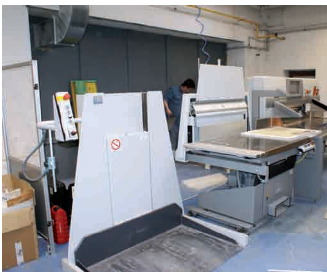
Řezací centrum POLAR 137 XT Plus se zdvihem a střešacím zařízením.
