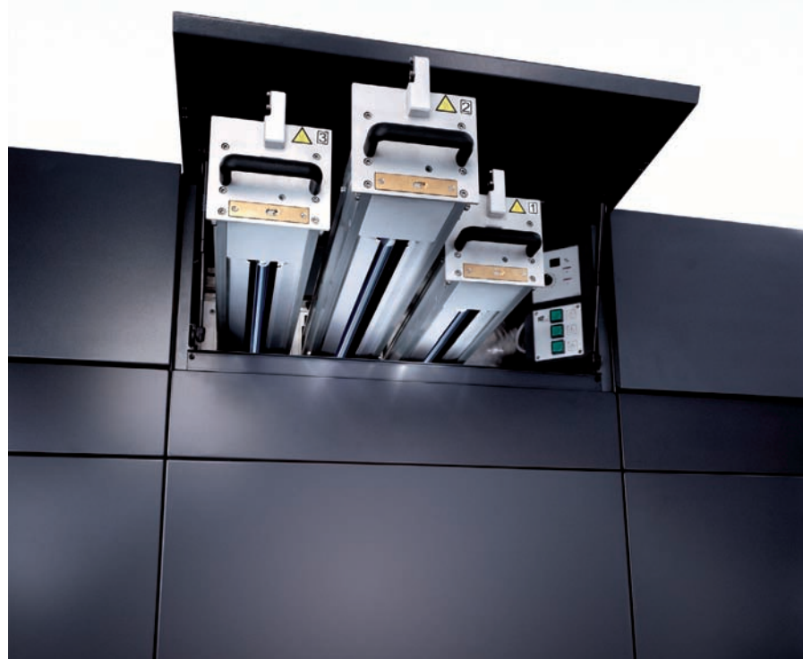
Stroje s technologií LE UV mohou být vybaveny jednou až třemi UV lampami. Již jedna lampy zajistí dostatečný výkon na zasušení čtyřbarvového tisku.
