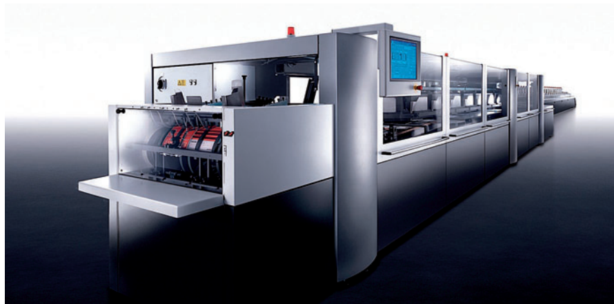
Eurobind Pro je plně automatizovaná linka lepené vazby V2 s výkonem až 6 000 cyklů za hodinu.
