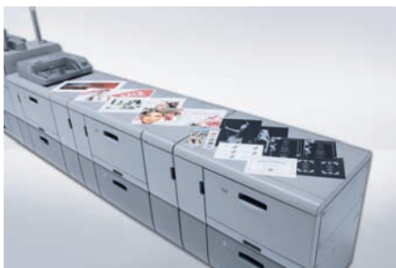
Až tři vysokokapacitní nakladače v sérii s celkovou kapacitou až 14 700 archů
