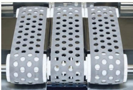
Podtlakový transport substrátu pro bezproblémový tisk na široké spektrum materiálů
