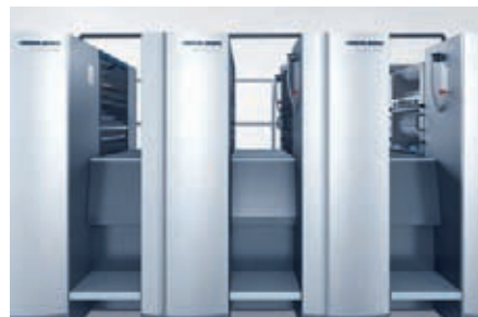
Štědrý prostor mezi tiskovými věžemi v kombinaci se sklopnými schůdky zaručuje rychlé a jednoduché ovládání stroje.
