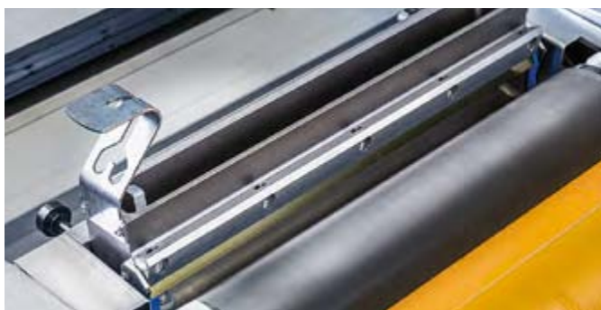
Komorová rakle zamezují vytváření pěny a zajišťují optimální přenos barvy nebo laku
