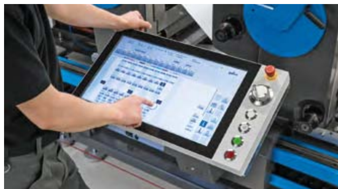
Ovládání stroje je mimořádně jednoduché. Centrální řídicí pult s dotykovým displejem je posuvný podél celého stroje
