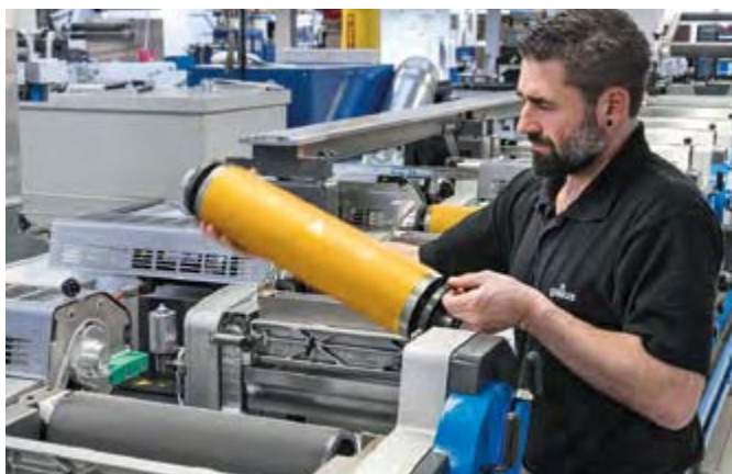
Výměna nových, odlehčených hliníkových válců s tiskovou formou zabere jen pár vteřin
