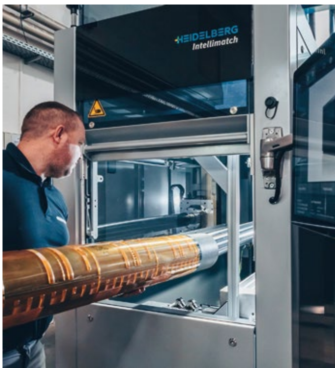
Intellimatch zajišťuje kontrolu a naskenování tiskové formy před jejím vložením do stroje. Získaná data slouží k plně automatickému nastavení tiskové jednotky na dané parametry, což dále zrychluje přípravu na novou zakázku a snižuje makulaturu na méně než 10 metrů.
