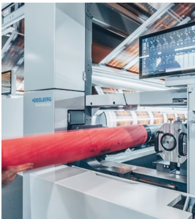
Tiskové věže jsou vybaveny dvěma tiskovými jednotkami. V době, kdy jedna jednotka tiskne, je možné druhou připravovat na další zakázku. Díky tomuto systému paralelní přípravy jsou neproduktivní přípravné časy stroje stlačeny na nulu.
