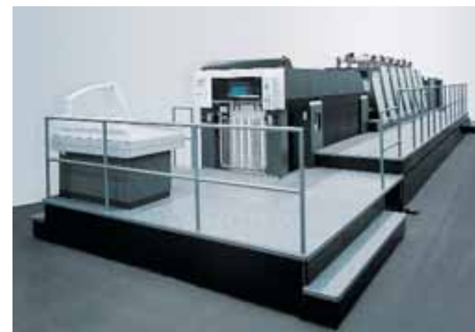
„Formel 1“ im Schöndruck: Dank einer Reihe von Neuerungen kann die Speedmaster CD 74 nun ein Tempo von fünf Bogen pro Sekunde erreichen.
