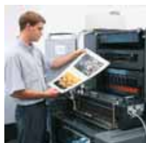
Nun ist das inline Lackieren mit der Laco Lackiereinrichtung auch auf der Speedmaster SM 52 und der Printmaster PM 52 möglich.
