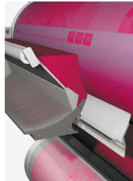
Das Kammerrakelsystem, bestehend aus Farbkammer und Raketmesser, befüllt die Rasterwalze mit Farbe.
