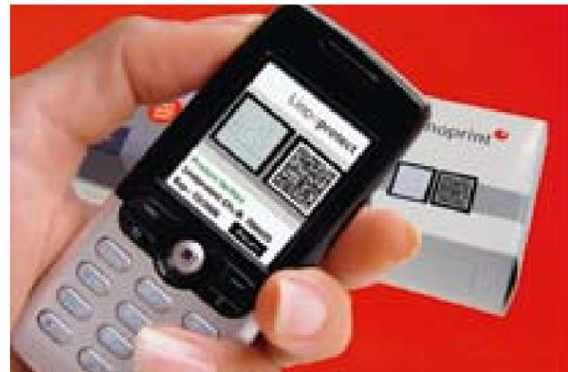
Doppelt gemoppelt hält besser: Linoprotect druckt definierte Zufallsmuster als verschlüsselte Datencodes und ermöglicht so jedem Konsumenten die Analyse von Original und Fälschung per Fotohandy.
