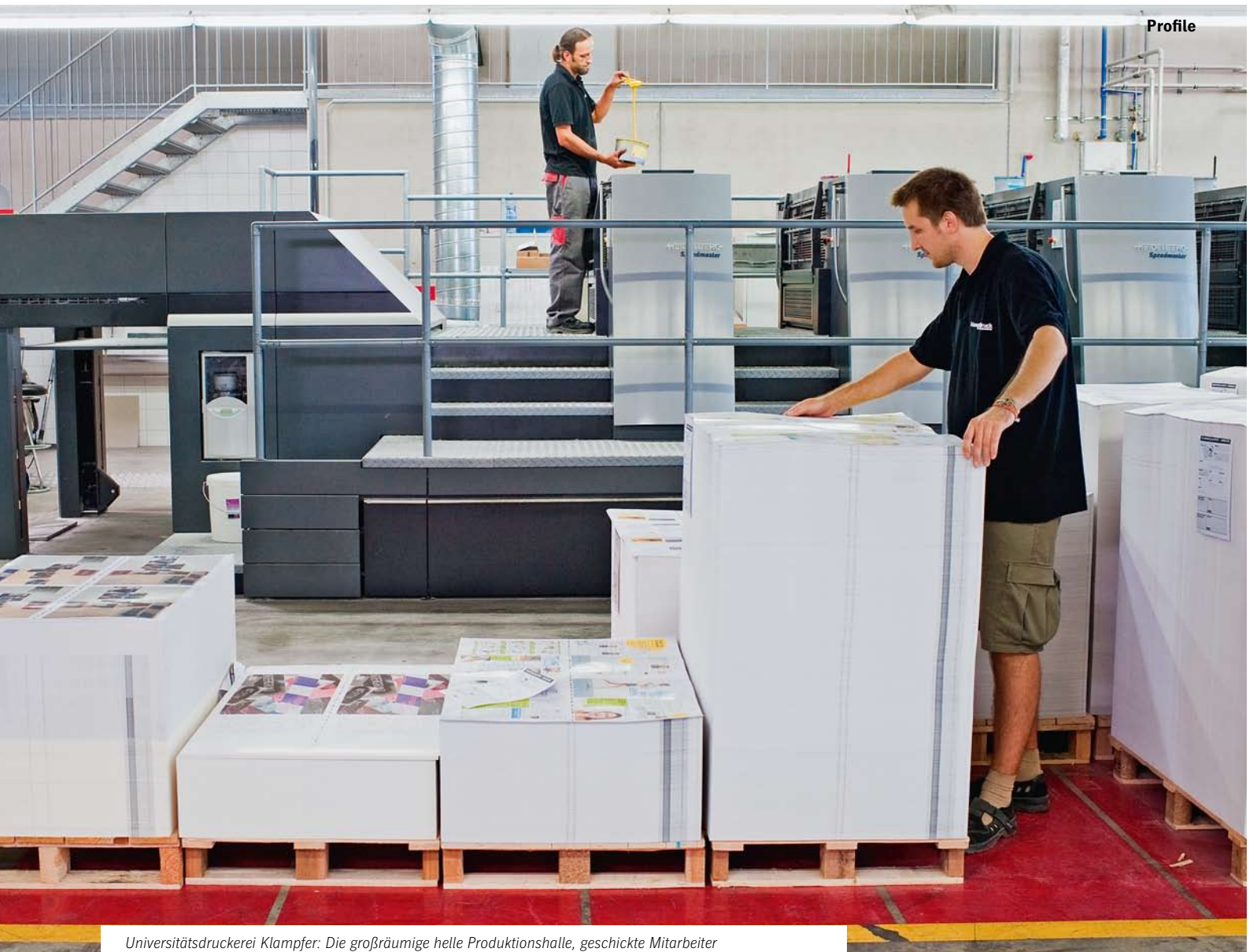
Universitätsdruckerei Klampfer: Die großräumige helle Produktionshalle, geschickte Mitarbeiter und die Speedmaster XL 105 mit Wendung bieten beste Voraussetzungen für eine produktive Arbeit.
