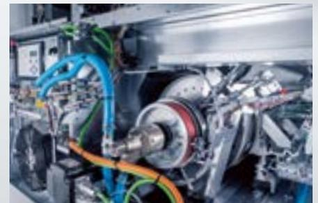
Die **Temperierung** der Laser und Zylinder standardisiert die Bedingungen, unter denen die Platten belichtet werden.
