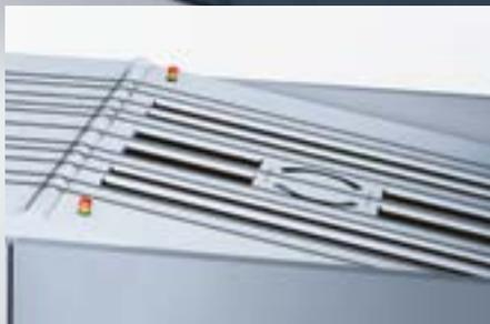
Der **Dual Cassette Loader (DCL)** mit integriertem Drehtisch automatisiert die Plattenbeladung der Suprasetter.
