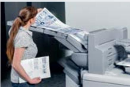
**Bannerdruck** bis 1.260 mm einseitig oder 1.030 mm beidseitig bedruckt. Geeignet für die Produktion von Sechs- bis Achtseitern sowie großen Postern auf einem Bogen.
