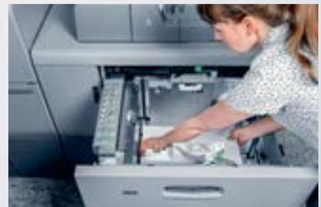
Zwei große **Vakuumanlegefächer (Vacuum Feed LCT)** mit optimierter Bogenführung für die seitliche Stabilisierung des Stapels während der Zuführung.
