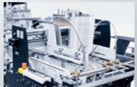
**Einleger und Zuschnittausrüstung** sorgen für eine präzise und stabile Schachtelzuführung mit zuverlässiger Schachtelausrichtung.
