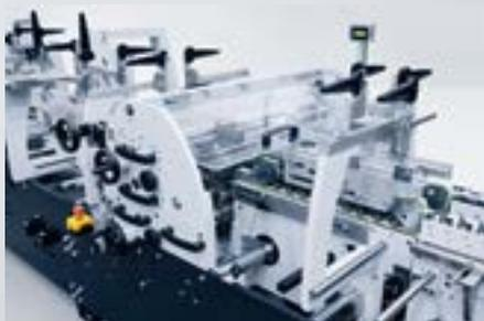
Das **Braille-Modul** prägt mit einer Maschinengeschwindigkeit von bis zu 250 m/min.
