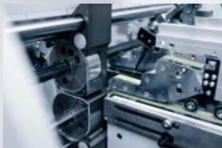
Die **digitale Positionskontrolle der Braille-Werkzeuge** sorgt für die exakte Platzierung der Prägung und somit für zuverlässige Produktionssicherheit.
