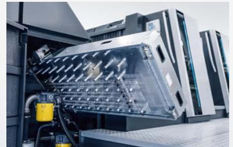
**DryStar Combination Eco** spart durch optimierten Eintrag, integrierte Wärmerückgewinnung und Isolation bis zu 30 Prozent Trocknungsenergie. Er gibt weniger Wärme an den Arbeitsplatz ab.
