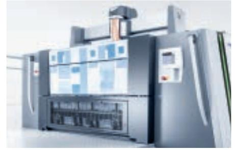
Simultaner Plattenwechsel mit AutoPlate XL 3 bei gleichzeitigem Gumm Tuch- und Druckzylinderwaschen.
