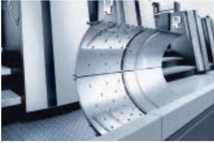
Venturi-Air-Jet-Technologie für kontaktfreien Bogentransfer nach der Wendung.
