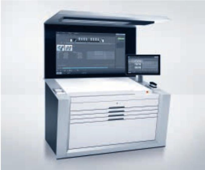
Modernes Arbeitsumfeld am Prinect Press Center XL 3 mit 24"-Multi-Touchscreen und LED-Farbprüfleuchte für eine optimale Bogenabstimmung.
