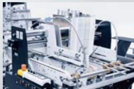
El **alimentador y la orientación de recortes** permiten una alimentación de cajas precisa y estable con una alineación fiable.
