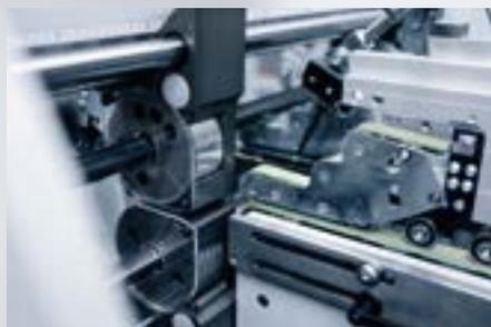
El **control de posición digital de las herramientas Braille** permite la colocación exacta del estampado y, por lo tanto, la fiabilidad de la producción.
