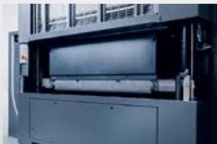
**Prinect Inspection Control 4** comprueba cada pliego en línea con cámaras en color de alta resolución en busca de errores antes de que se generen los costes que estos originarían.
