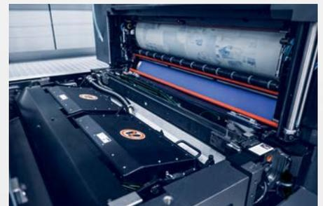
**Prinect Inspection Control 4** comprueba cada pliego en línea por ambas caras con dos cámaras en color de alta resolución en busca de motas, defectos de material, velos, salpicaduras, etc.
