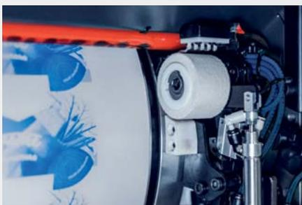
El sistema de cuidados de los **anillos de soporte** y los **rodillos de leva de gran volumen** reducen el mantenimiento manual y garantizan una producción fiable.
