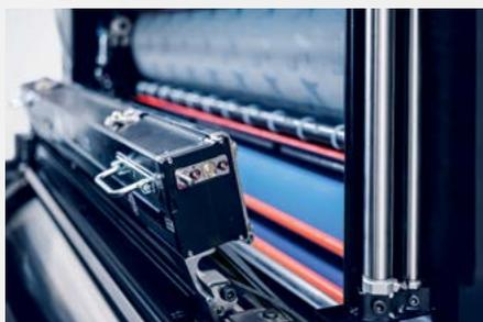
**Prinect Inpress Control 3** detecta automáticamente la tira de control, el blanco del papel y las marcas de registro e inicia la regulación del entintado sin intervención del operario.
