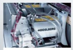
Le module laser propose une qualité exceptionnelle et une fiabilité optimale par le biais du système de diodes intelligent (IDS).
