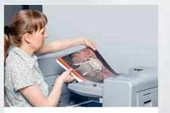
L'inserteur permet d'introduire des feuilles préimprimées dans la pile pendant la phase de production pour une finition en ligne fluide.
