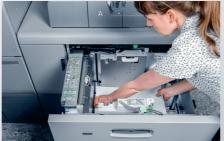
Deux grands bacs d'alimentation (Alimentation par aspiration LCT) avec contrôle optimisé de la feuille pour une stabilisation latérale de la pile pendant l'alimentation.
