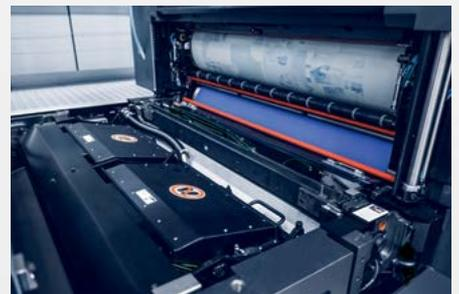
**Prinect Inspection Control 4** détecte les pétouilles, défauts de matériau, écarts de couleur, projections d'encre, etc. de chaque côté des feuilles à l'aide de deux caméras couleur.
