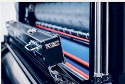
**Prinect Inpress Control 3** détecte automatiquement les bandes de contrôle, le blanc du papier et les marques de repérage et lance le processus de régulation sans intervention de l'opérateur.
