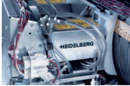
Lazer modülü, patentli Akıllı Diyot Sistemi (IDS) sayesinde üstün kalite ve yüksek düzeyde güvenilirlik sunar.
