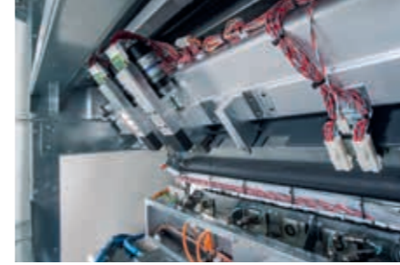
Entegre panç sistemi maksimum register doğruluğu ile çalışır. Bu, özellikle tekrarlanan işler için hazırlık sürelerini kısaltır.
