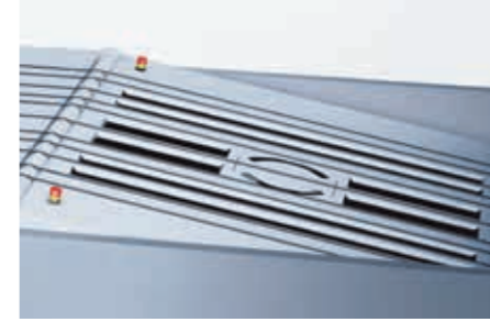
Entegre döner tablalı Çift Kaset Yükleyici (DCL), kalıpların Suprasetter'a yüklenmesini otomatik hale getirir.
