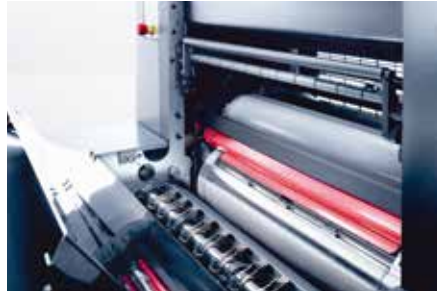
上光單元適合各種上光，包括整版保護性上光、局部上光、UV及特殊上光。
