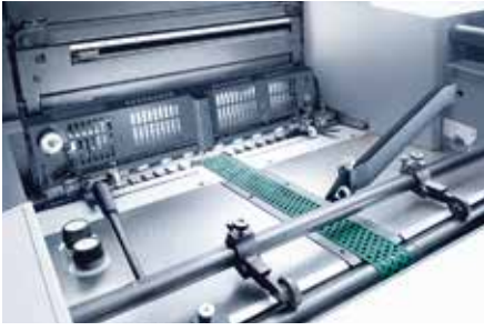
帶有中央吸氣帶的飛達從一開始就可以確保出色的生產率和穩定的輸紙。
