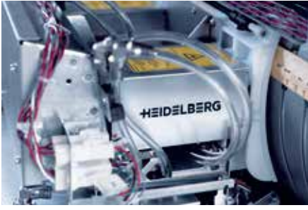
由海德堡開發並獲得專利的智慧二極體系統 (IDS) 系統保證了Suprasetter系列使用的雷射系統在保持卓越性能的同時，還具有高度可靠性。
