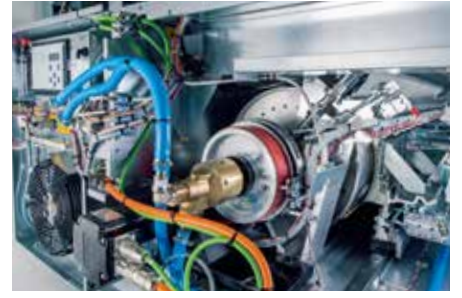
水冷恆溫系統可實現標準化的印版曝光環境條件。
