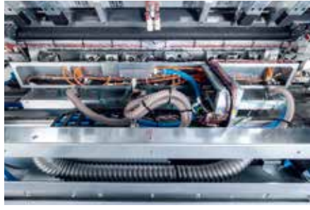
版粉移除系統 (Debris Removal System) 可清除從曝光過程中從印版釋出的顆粒和灰塵。
